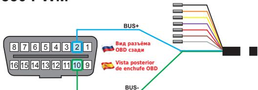
Разъём с трансмиссией в соответствии с протоколом **SAE J1850 PWM** имеет сигнальные контакты в коннекторах **2 и 10**. К проводу, выходящему из **2-ого** коннектора, припаиваем **синий** провод.
