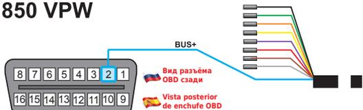
Разъём с трансмиссией в соответствии с протоколом **SAE J1850 VPW** имеет сигнальный контакт в коннекторе **2**. К проводу, выходящему из **2-ого** коннектора припаиваем **синий** провод.
